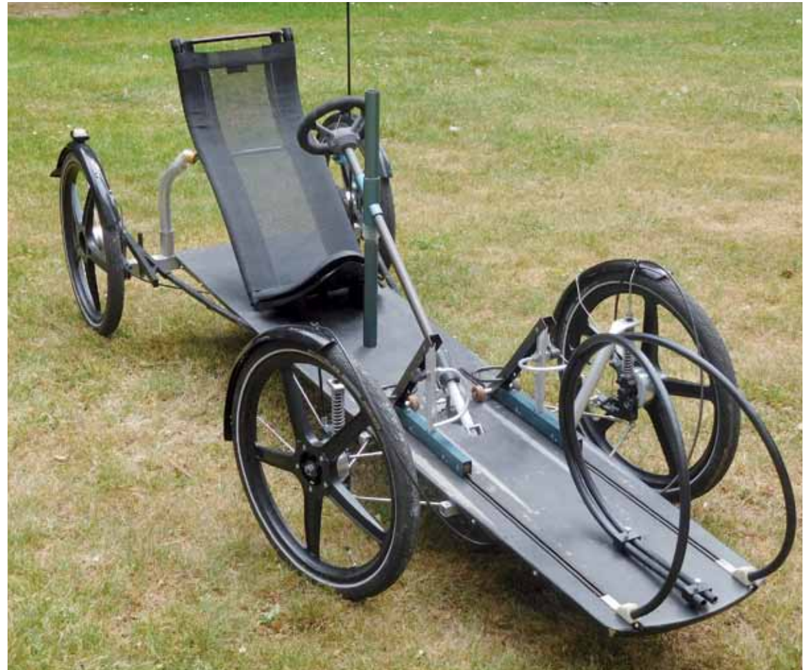
Elk pedaal grijpt in op zijn eigen riem. Deze riem wordt om het freewheel op de achterwielas gewikkeld.
